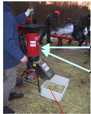
Entnahme einer Mischprobe aus dem Hackgut aller Triebe zur Bestimmung des Wassergehaltes
